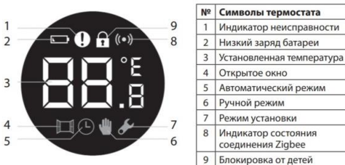
Рис. Устройство термостата
